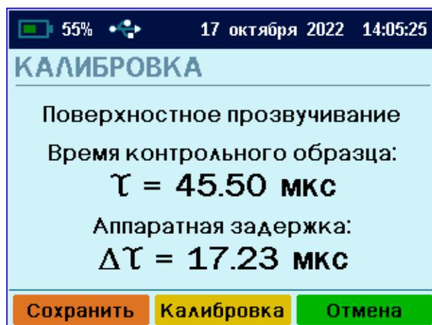
**Для датчика поверхностного прозвучивания:** Установить датчик на контрольный образец из оргстекла, удерживать датчик неподвижным в плоскости перпендикулярной к поверхности образца и прижать с усилием 5...10 кг.
